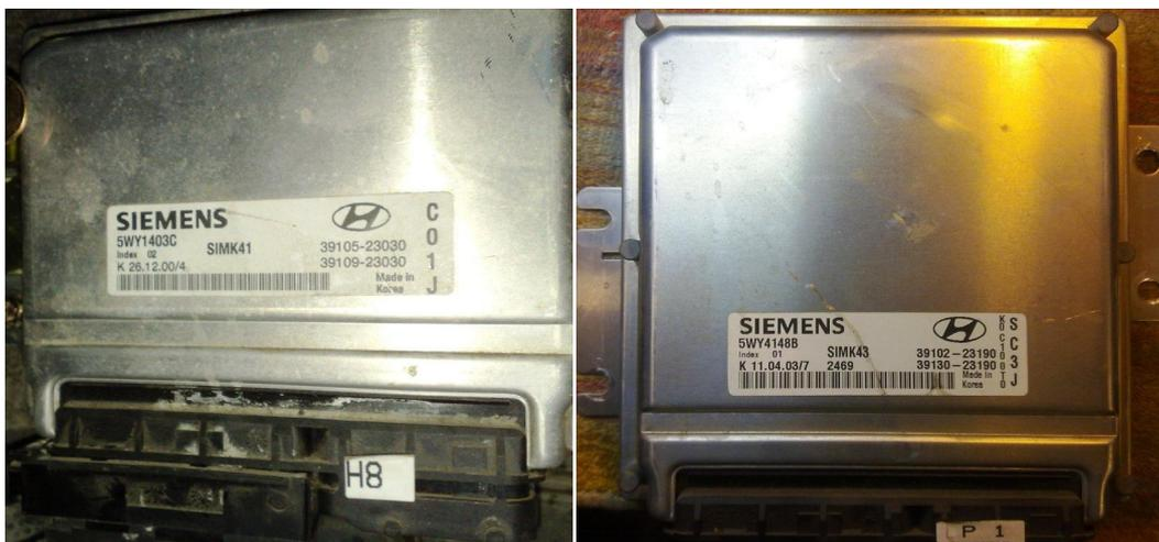
Как правило ЭБУ расположены в салоне автомобиля над левым коленом водителя и крепятся через пластину-переходник двумя гайками и одним болтом.
